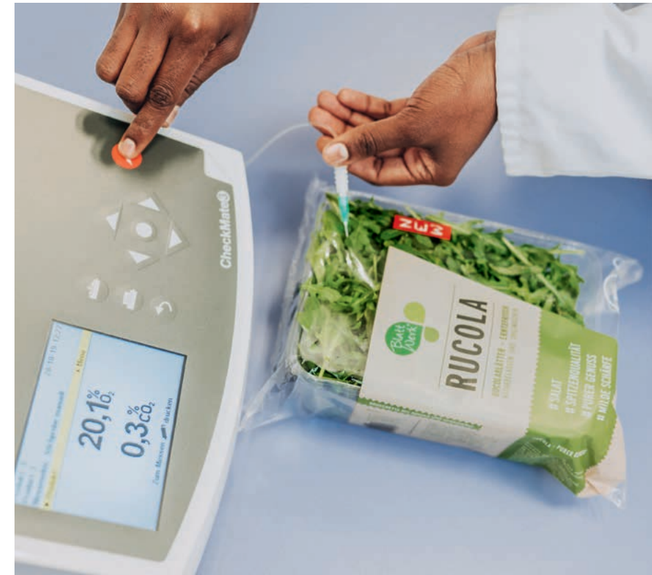
Alles gut da drin? Der Gasanalysator misst Sauerstoff- und Kohlendioxidgehalt in Verpackungen, um herauszufinden, mit welcher Gasmischung Rucola am längsten frisch bleibt.
