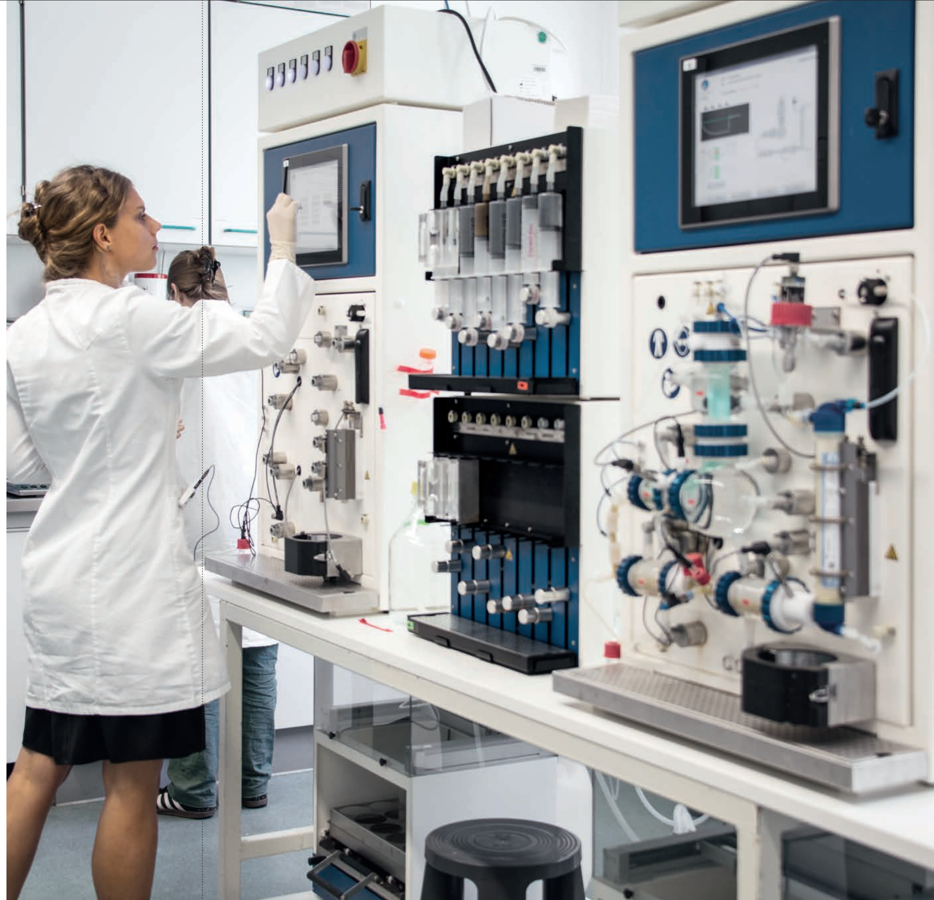
Eine Mitarbeiterin des Max Rubner-Instituts (MRI) bereitet eines der beiden abgebildeten Tiny-TIM-Modelle für einen Versuch vor, in dem sie Verdauungsprozesse wie in Magen und Dünndarm simuliert. Am Monitor der Haupteinheit wählt sie das Programm: Für jedes Lebensmittel und jede Mahlzeit kann sie einen passenden Algorithmus eingeben. In der Mitte befinden sich Einheiten, durch die zum Beispiel Mischungen von Verdauungsenzymen, Galle und Salzsäure in den Nahrungsbrei hinzugegeben werden. Die Einheiten unter dem Tisch fangen die zu untersuchenden Proben auf.
