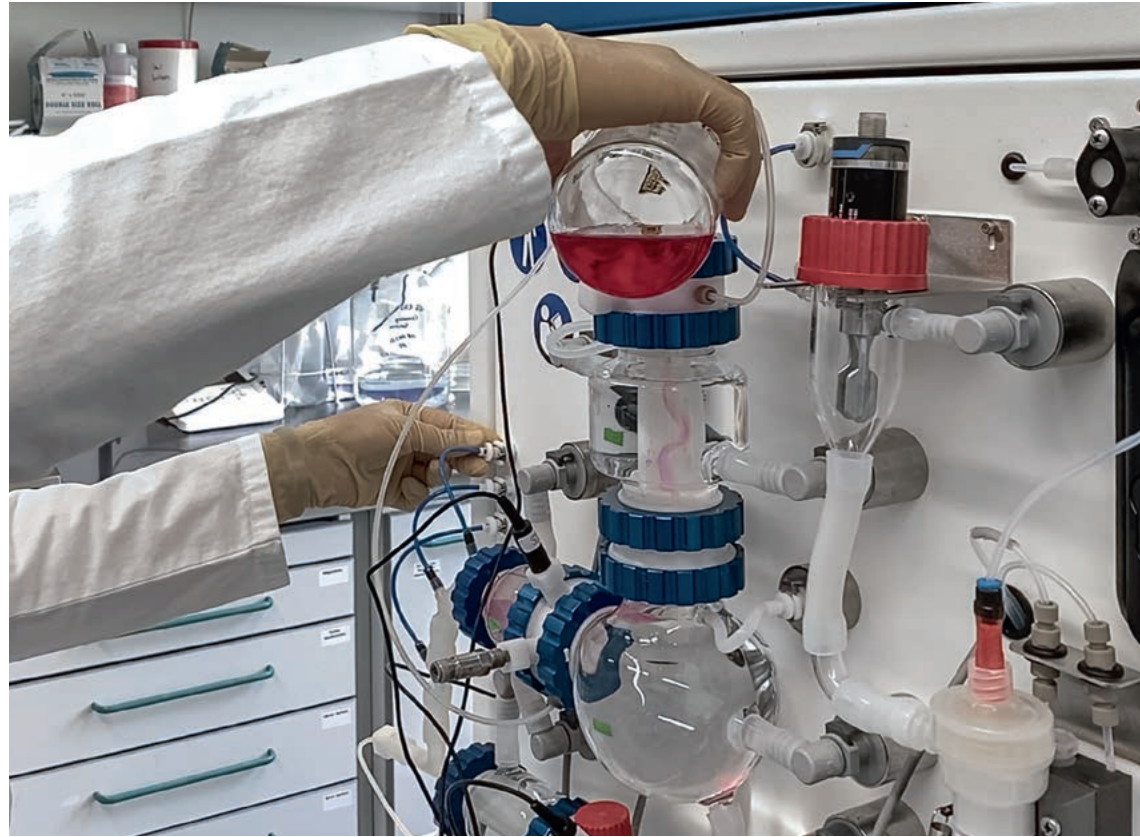
Tiny-TIM wird mit Aronia-saft befüllt. Sobald die Flüssigkeit im Modell ist, wird es dicht verschlossen und der Verdauungsversuch kann beginnen. Je nach Lebensmittel kann der Versuch zwischen drei und sechs Stunden dauern.
