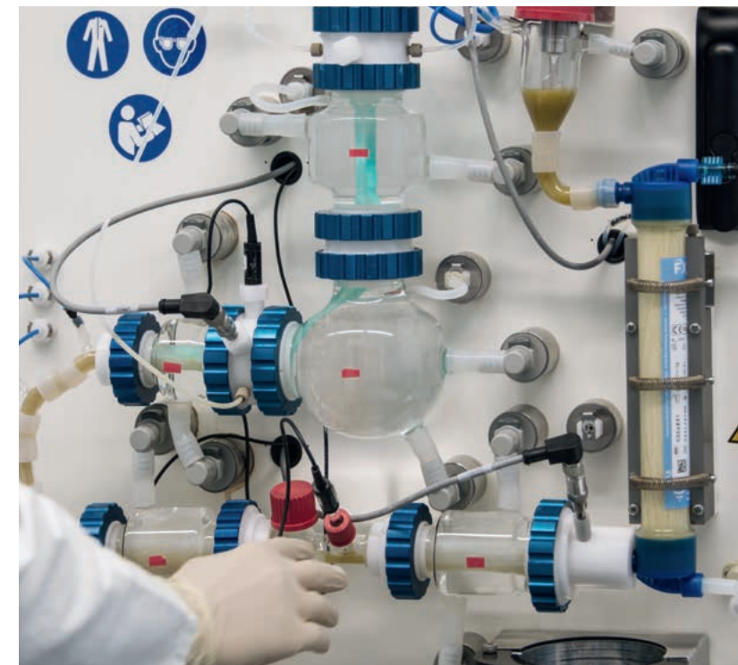
Die Schläuche, die in den Glasgefäßen verlaufen, entsprechen Magen und Dünndarm des Modells. Sie sind von Wasser umgeben, das auf 37 Grad Celsius temperiert ist. Am Ende werden Nährstoffe mithilfe eines Dialyseverfahrens herausgefiltert, gesammelt und chemisch analysiert.
