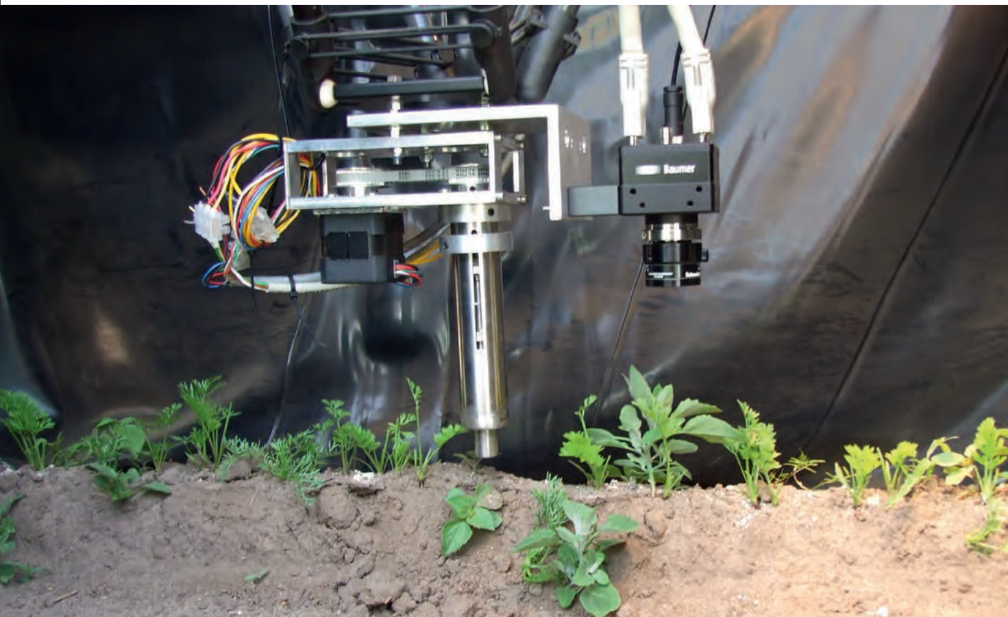
BoniRob hat gelernt, Kulturpflanzen von Unkraut zu unterscheiden. Unerwünschtes Grün rammt die Maschine anschließend mit einem Metallstift in den Boden.
