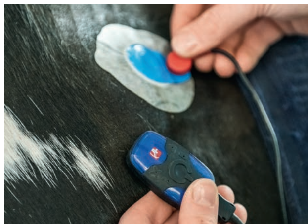
Mit Sensoren wird die Atemfrequenz der Tiere gemessen.
