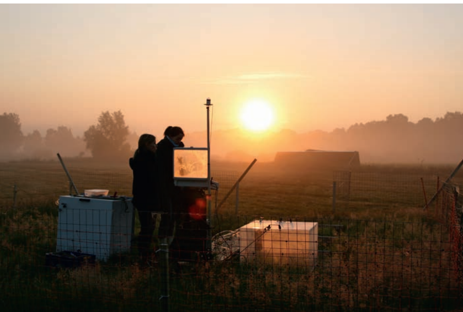
Messung der CO 2 -Emission aus einem norddeutschen Moorboden
